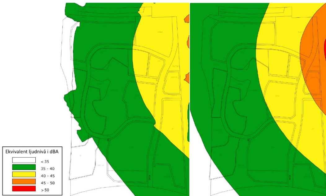
Kartor ur Efterklang's bullerutredning. Kartorna illustrerar nuvarande ekvivalenta ljudnivåer av industribuller inom planområdet. Till vänster visas ljudnivån 1,5 m ovan mark och till höger visas ljudnivån 16,5 m ovan mark.
